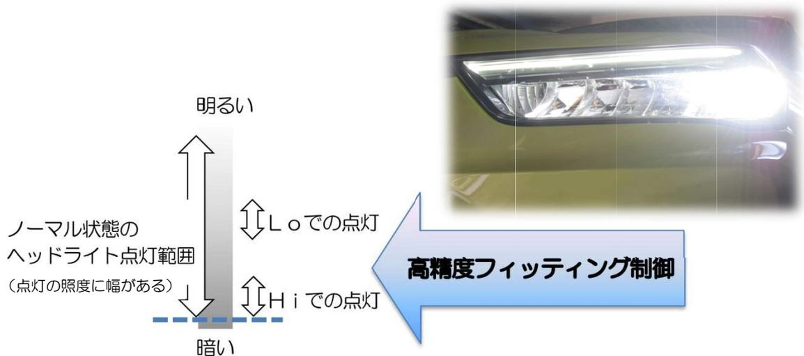
高精度フィッティング制御とは当社が開発した制御方式で日の出から日没までの時間帯においてヘッドライトの点灯照度をより正確に制御するものです。
